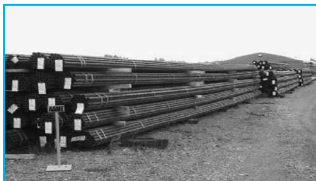
Figura 4: feixes de tubos economizadores conforme recebidos na oficina de fabricação de caldeiras.
